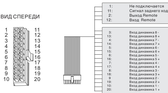
Сигнал заднего хода (подключается к лампе заднего хода). При получении плюсового сигнала на этот провод усилитель отключает сигнал с блока MSB и берёт входящий сигнал с головного устройства. Таким образом обеспечивается озвучивание парктроника при движении задним ходом.
