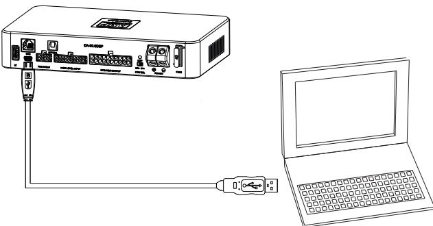
Подключите ПК к разъему USB усилителя DA-60.8DSP с помощью прилагаемого USB-кабеля.
