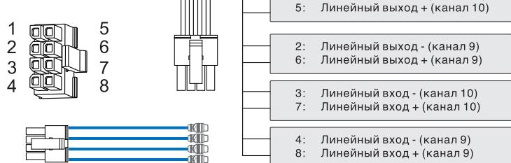
Жгут с двумя парами RCA разъёмов.
